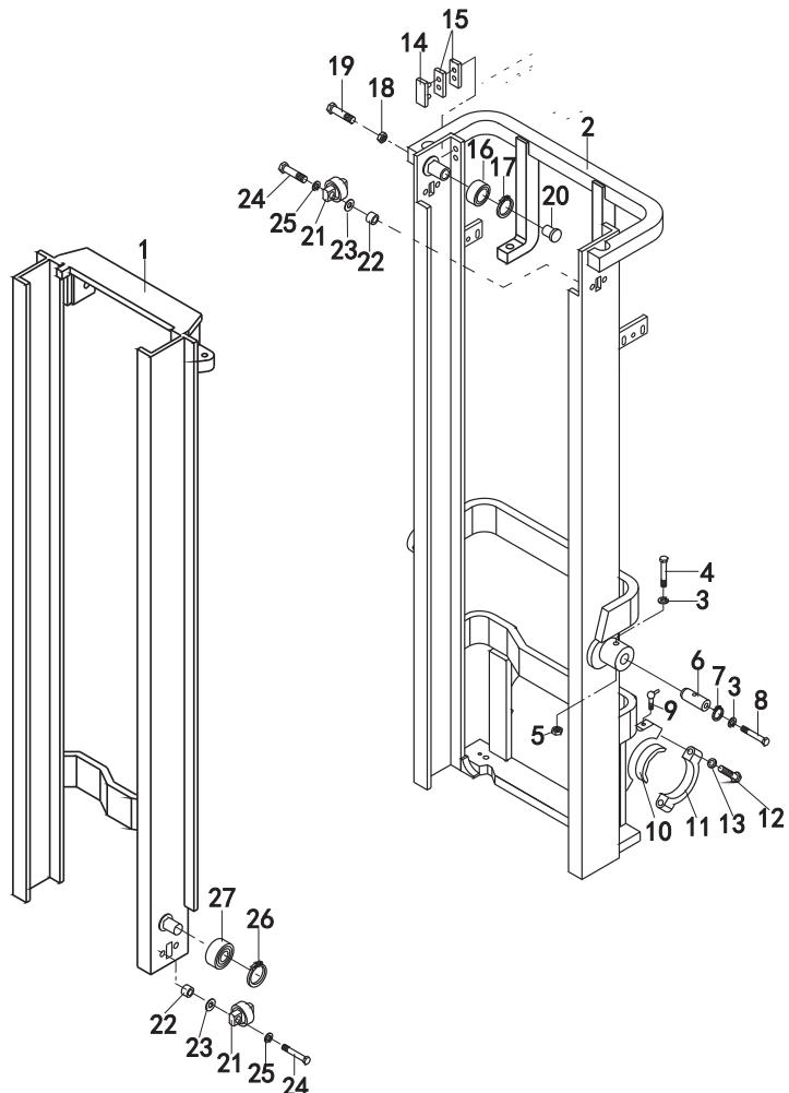
起升油缸（基本型）/LIFT CYLINDER(NORMAL MAST)
