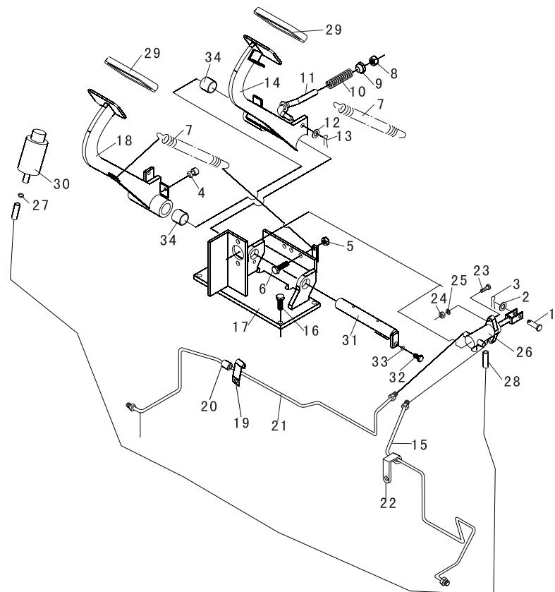
行车制动与离合操纵/BRAKE & CLUTCH CONTROL
